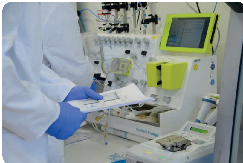
Gentherapeutische Zellherstellung am CliniMACS Prodigy Gerät
